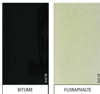
Bitume conventionnel et Shell Floraphalte en film mince Thin coat of conventional Bitumen and Shell Floraphalte
